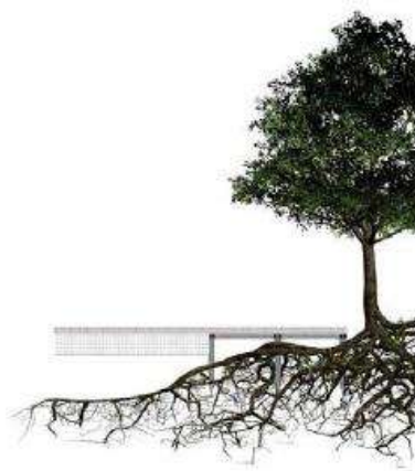
3 pav. Šaknis saugančio pakabinamo tiltelio įrengimas
